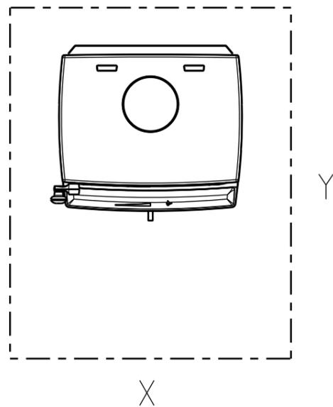
Min. Abmessungen der Fußbodenplatte
