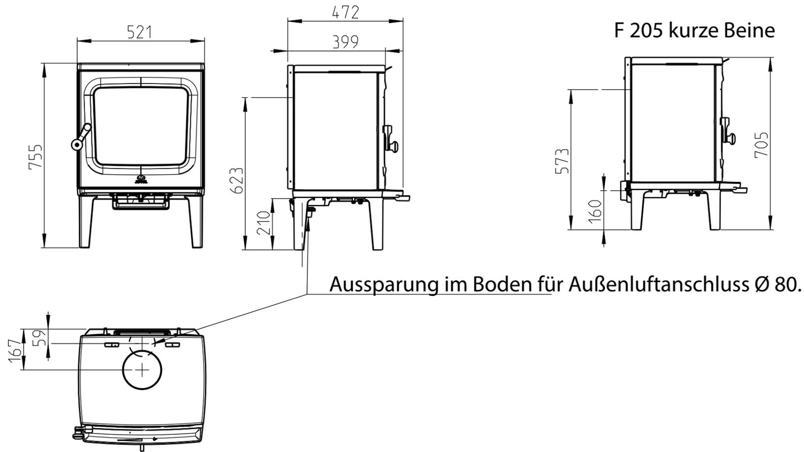
Aussparung im Boden für Außenluftanschluss Ø 80.
